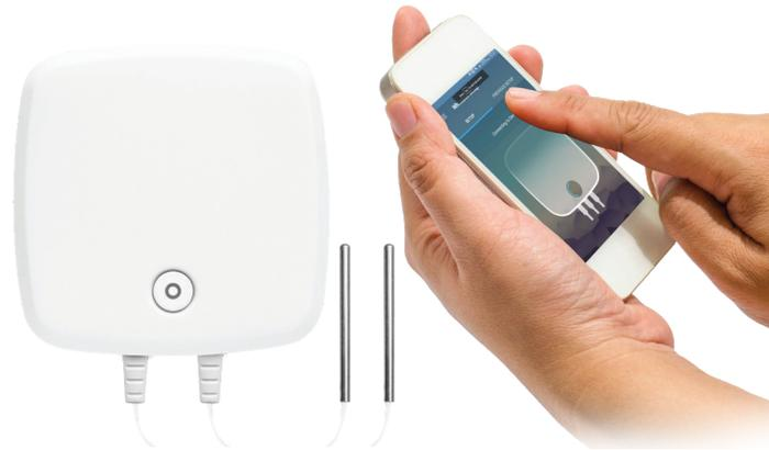
Il kit EL-MOTE-DTP è stato progettato per monitorare la temperatura in un'ampia gamma di applicazioni, utilizzando sonde di temperatura con aste di 75 mm di lunghezza su cavi di 3 m. Ideale per il monitoraggio di posizioni forse difficili o inospitali per il data logger stesso, EL-MOTE-DTP è ideale per il monitoraggio di unità di refrigerazione o di stoccaggio. Questo kit ha 2 canali per monitorare contemporaneamente 2 aree separate, ad esempio un frigorifero e un congelatore.
