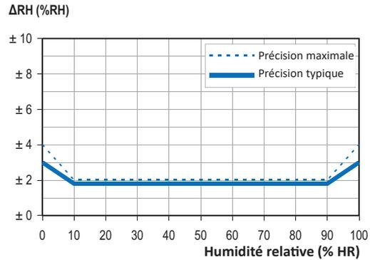
Précision typique des mesures d'humidité relative données en % HR pour des températures de 0 à 80°C.
