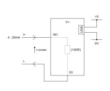
MESSUNG VON 4 - 20 mA MIT EINER USB-STROMVERSORGUNG
