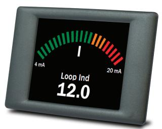
Das SGD 24-M ist ein mit PanelPilot kompatibles Grafikdisplay mit Farbdisplay in einer Auflösung von 320 x 240 Pixeln (QVGA) und USB-Programmierschnittstelle.
